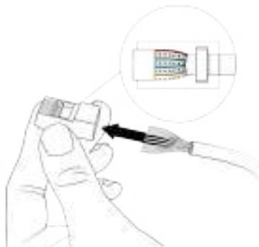
2. Connectez la fiche RJ45 du câble réseau au socle de prise CT IN.
