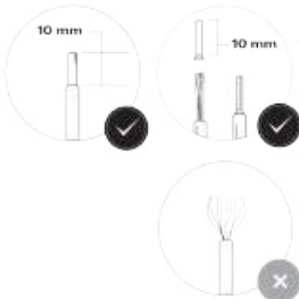
2. Connectez les fils de contrôle de puissance active au bornier noir (entrée numérique 1).
