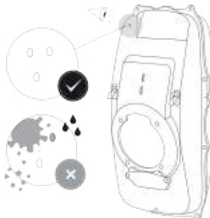
3. Sur la borne de recharge, vérifiez que le joint traversant pour le câble de l'affichage est correctement installé.
